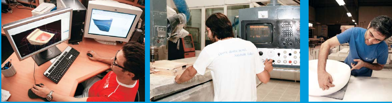
SEREL Tasarım Ekibi'nin ortaya çıkardığı tasarımlar (solda) daha sonra kalıp atölyesinde (ortada ve sağda) modelleme yöntemiyle üçboyutlu hale getiriliyor. Tasarım aşamasında uygulanan bu prosedür, üretimde yaşanacak sorunların minimum düzeye indirilmesini sağlıyor. Ekibin çizdiği sıradışı tasarımlar altı aylık bir süreçte üretime hazır hale geliyor.
