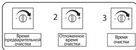
Настройки времени подачи воды Easy-Wash Вы можете настроить параметры времени очистки для умывальников Easy-Wash с помощью блока управления водителем Poseidon. Отвинтите крышку блока управления с помощью отвертки. Внутри блока есть три установочных винта, как показано на соседнем рисунке;
